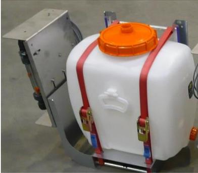
Der DSG 160/60 (LSP 60 ST) ist ein robustes, leistungsfähiges Gerät zur Ausbringung von Siliermitteln auf Basis von Milchsäurebakterien / Flüssigprodukten
